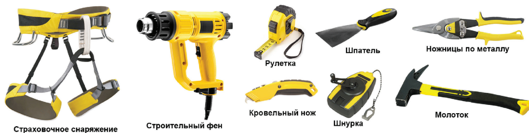
Рис. 2 Перечень инструментов монтажника
