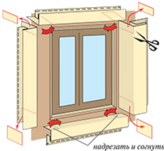
Технология монтажа такая же, как и у наличника. Разница заключается только в подрезке околооконного профиля и установке по периметру окна финишной планки.
