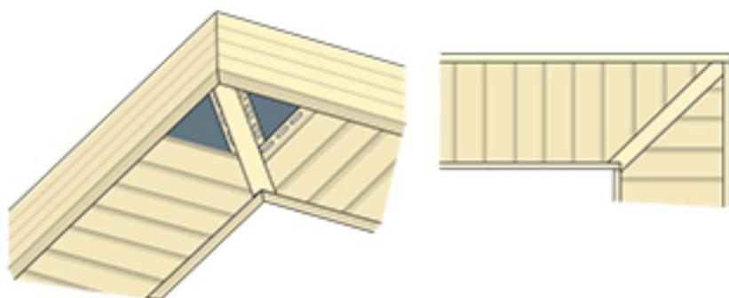
Соффит устанавливается между молдингом и J-фаской. Технология монтажа соффита очень проста: отрезается панель нужного размера за вычетом зазора на установку. Один конец заводится в молдинг, другой в J-фаску и фиксируется саморезом. Следующий соффит монтируется таким же образом и защелкивается в замок первого, и так далее.
