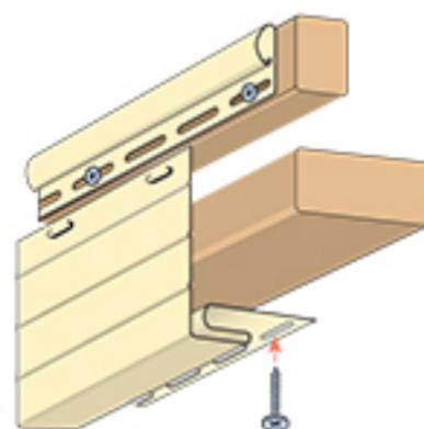
Горизонтальные J-фаски устанавливают по правилам крепления горизонтальных элементов, наклонные J-фаски крепят по правилам установки вертикальных элементов. К верхней кромке ветровой доски крепится финишный профиль. Фаска защелкивается в финишную планку на «зацепы». При необходимости удлинить J-фаску элементы закрепляются внахлест на величину 25 мм.
