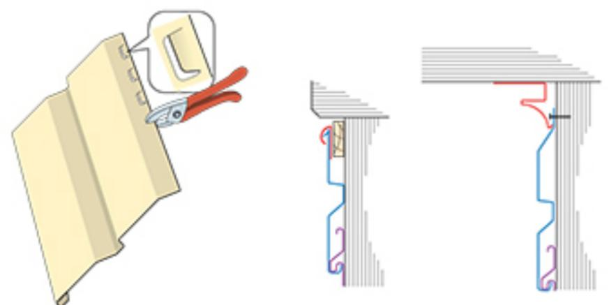
Монтаж панелей заканчивается в финишном профиле или молдинге, для чего необходимо сделать «зацепы» в верхней части панели для установки в финишный профиль, или закрепить сайдинг через дополнительное гвоздевое отверстие, которое необходимо закрыть молдингом.
