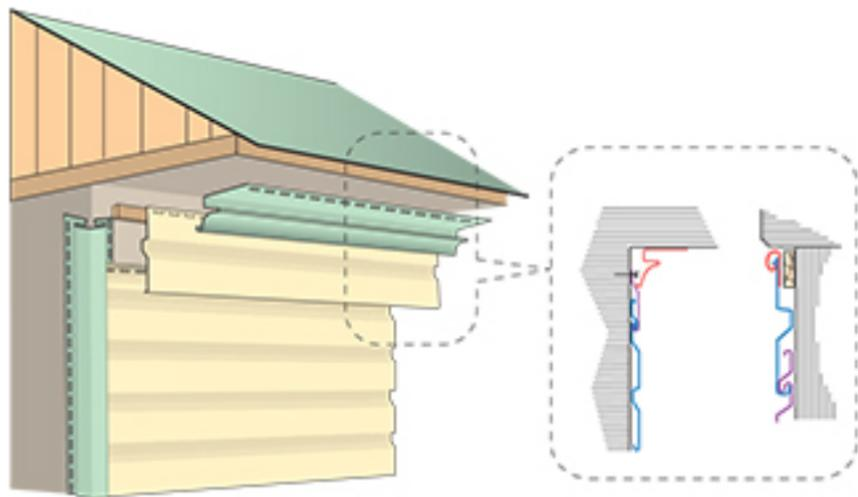
Сайдинг монтируется от стартового профиля. Убедитесь, что замок панели полностью защелкнулся по всей длине. Не тяните сайдинг слишком сильно, вы можете изогнуть зацепление. Проверьте, может ли панель скользить по всей длине, после чего закрепите панель. Крепеж производится только по центру гвоздевых отверстий. Аналогично монтируются все последующие панели. Не забывайте, что необходимо оставлять тепловой зазор. Монтаж панелей заканчивается в финишном профиле или молдинге (см. п.8).
