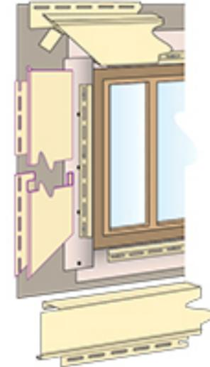
Наличник 89 мм Döcke. Заготавливаются отрезки стартового профиля и наличники на оконный проем. Перед установкой наличника по всему периметру окна устанавливаются отрезки стартового профиля. Длина всех элементов должна быть равной, соответственно, длине и высоте проема плюс две ширины используемых наличников. У верхнего наличника в изгибе с обеих сторон делаются надрезы длиной 20 мм, и получившиеся «язычки» отгибаются вниз, по ним вода с верхнего наличника будет отводиться за боковые.
