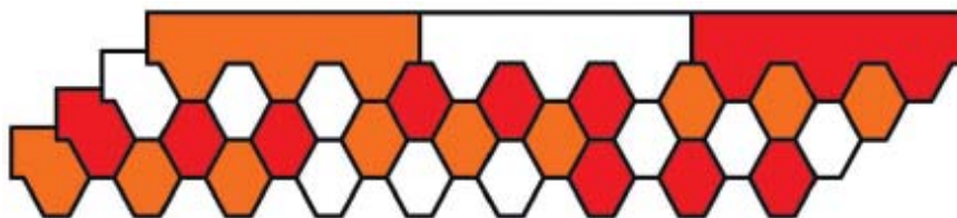
Рис. 16 Схема чередования гонтов гибкой битумной черепицы Döcke PIE.
