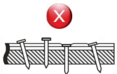
Рис. 3 Пример неправильной забивки гвоздей при монтаже продукции.
