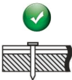
Рис. 2 Пример правильной забивки гвоздей при монтаже продукции.
